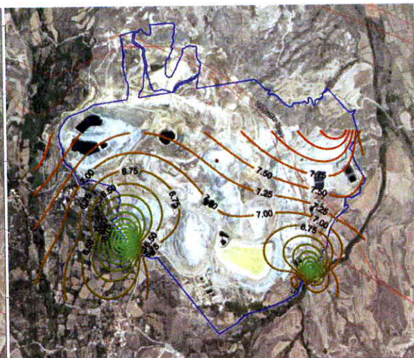
Εικ.10 Ισορρυπαντικές καμπύλες pH από τη δειγματοληψία νερών σε σημεία της μίσθωσης
