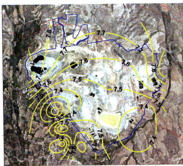
Εικ.9 Ισορρυπαντικές καμπύλες pH από τη δειγματοληψία εδάφους (30cm) σε σημεία της μίσθωσης
