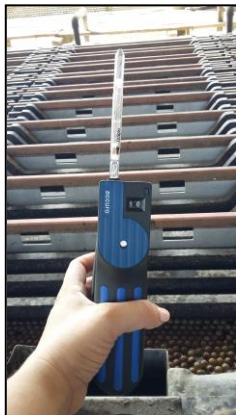
Εικόνες 8,9: Μετρήσεις acid mist στον χώρο της ηλεκτρόλυσης
