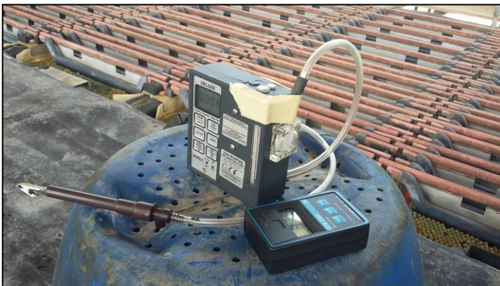
Εικόνες 8,9: Μετρήσεις acid mist στον χώρο της ηλεκτρόλυσης
